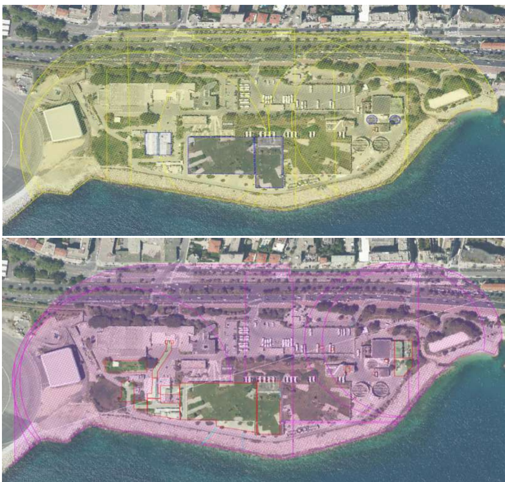
Figure 116 : Rayons d'influence des pompages durant les phases de démolition (en jaune) et de terrassements/construction (en rose)
