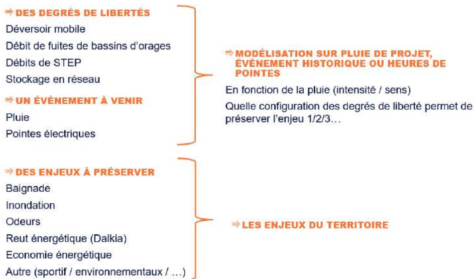
Figure 165 : Approche conceptuelle de la gestion dynamique du système d'assainissement d'HALIOTIS
