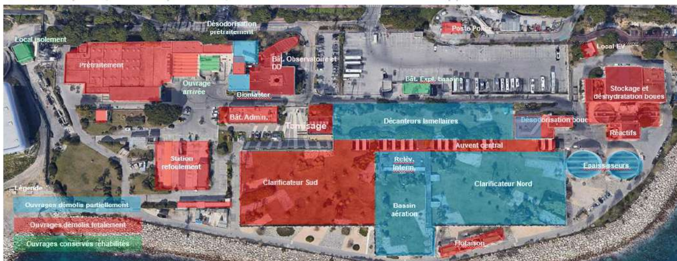
Figure 144 : Localisation des ouvrages qui seront démolis (en rouge), partiellement démolis (en bleu) et conservés (en vert)
