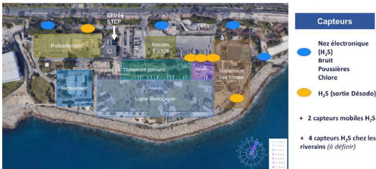
Figure 185 : Localisation des capteurs olfactifs et sonores
